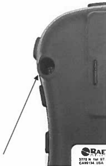
Рисунок 2 - Место пломбировки корпуса для ограничения несанкционированного доступа
