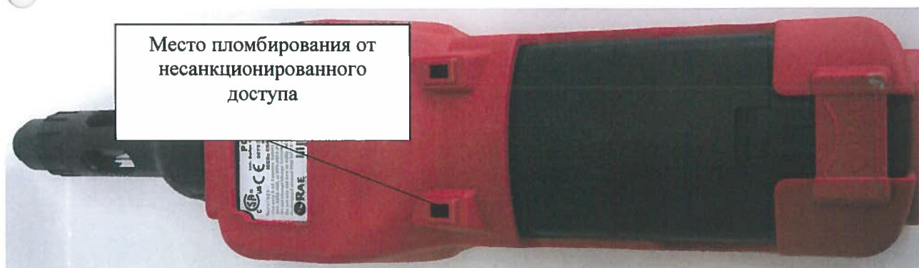
Рисунок 2 - Схема пломбирования газоанализаторов от несанкционированного доступа (на примере корпуса UltraRAE 3000)
