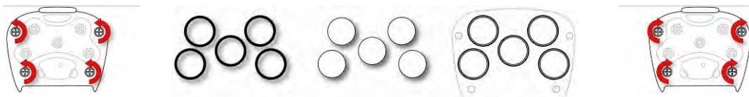
Выкрутите четыре винта, которые фиксируют крышку отсека с датчиками.
