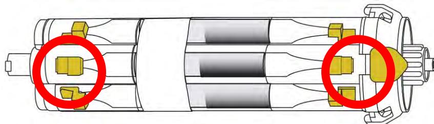
Чтобы обломать конец трубы, следует надавить на выступ. (Осколки остаются внутри контейнера.)
