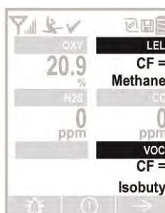
Если газоанализатор используется в режиме для определения TVOC, на экране MultiRAE Benzene непрерывно отображаются все показания датчика.
