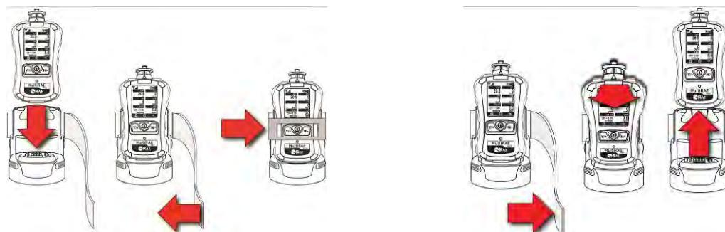
**Чтобы зафиксировать прибор MultiRAE, прижмите его к док-станции и закрепите контактную ленту.**
