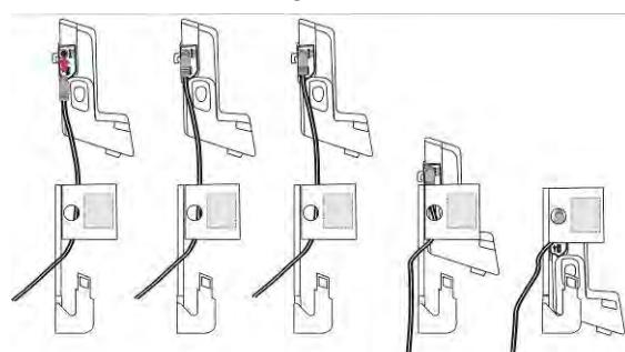
Поместите устройство MultiRAE в док-станцию (убедитесь, что нижняя часть устройства и направляющие штифты на док-станции правильно совмещаются) и нажмите на него, чтобы зафиксировать. Затем оберните контактную ленту вокруг прибора MultiRAE и зафиксируйте ее конец на стороне крепления Truck Mount.
