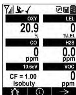
Когда прибор MultiRAE наклонен, датчик гравитации определяет его положение в пространстве и экран поворачивается соответствующим образом.
