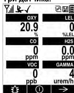
Шесть датчиков, в том числе комбинированный датчик CO+H<sub>2</sub>S.
