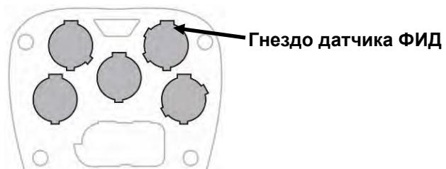
6. Если необходимо открыть модуль датчиков для осмотра или очистки лампы и панели электродов датчика, следует использовать специальный инструмент (PN G02-0306-003, три в упаковке). На С-образной стороне инструмента имеются небольшие зубцы. Подведите инструмент таким образом, чтобы его зубцы совпали с бороздками между крышкой и корпусом модуля:
